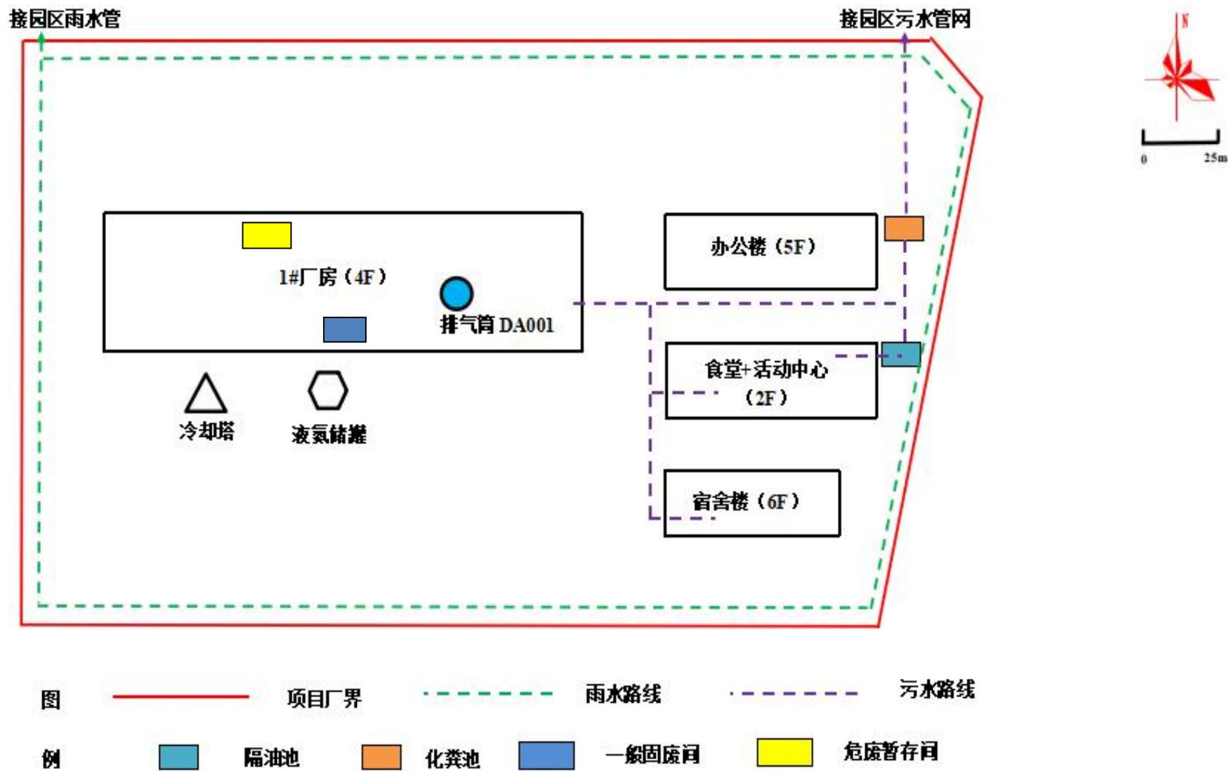
附图 3-1 项目总平面布置及雨污管网图
